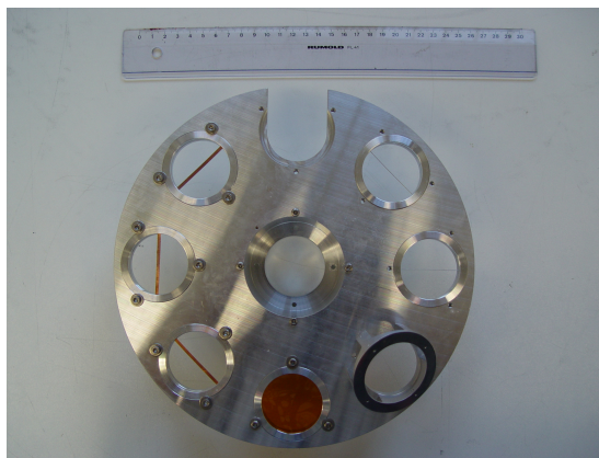
Abbildung 4.2: Radiatorscheibe mit verschiedenen Radiatoren und Werkzeug zur Untersuchung des Strahlprofils.
